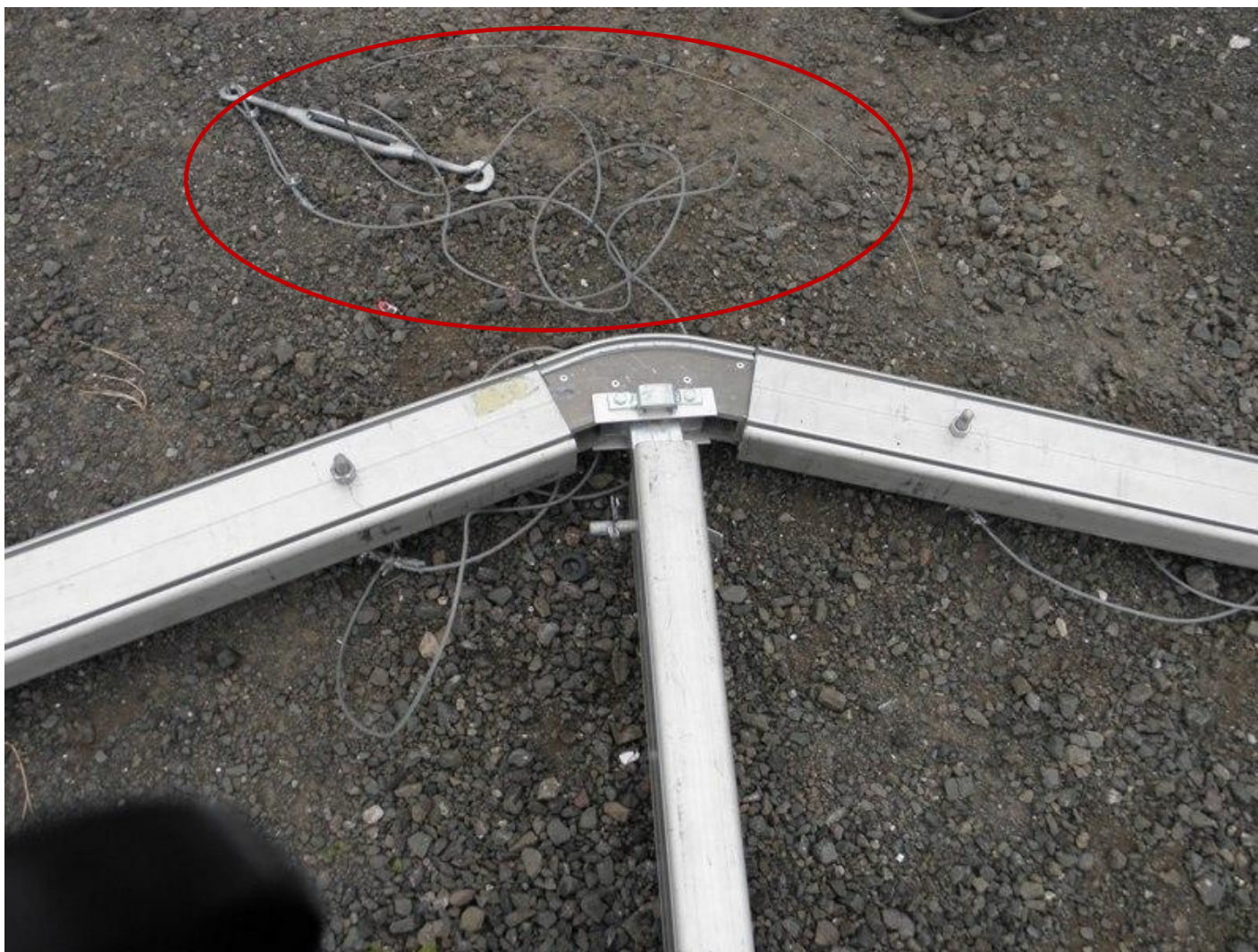
Závětrovací lana (ocelová) 8 ks
